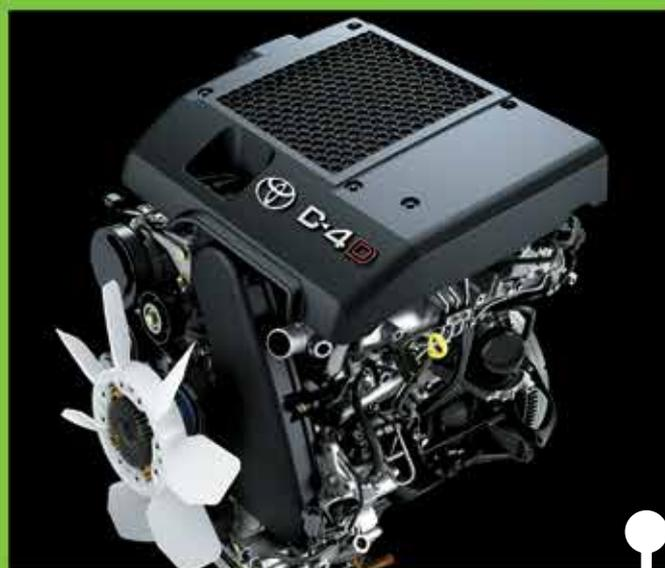
Para los motores Diésel es utilizada la tecnología "Common Rail" conocida como D-4D, la cual mediante la precisión en la inyección del combustible brinda mayor rendimiento y reduce las emisiones de CO<sub>2</sub>.
