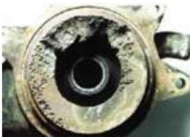
Cavitación de bomba de agua por uso de refrigerante genérico
