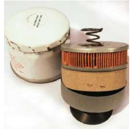
El empaque del filtro de aceite genérico se puede volver elástico bajo altas temperaturas y/o presiones, causando deficiencia en el sellado y pérdida de aceite del motor en pleno funcionamiento.
