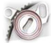
**Tensor de la faja original:** Depende del modelo puede ser un rol o un tensor separado, si este no se cambia la faja no tiene tensión y puede brincar incluso reventarse.
